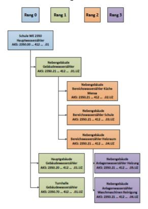
**Bild 1** Verknüpfung von Hauptwasserzählern und mehreren Unterzählern
